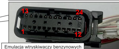
Emulacja wtryskiwaczy benzynowych Petrol injectors emulation эмуляция бензиновых инжекторов
