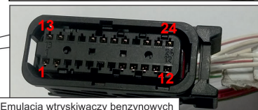
Emulacja wtryskiwaczy benzynowych Petrol injectors emulation эмуляция бензиновых инжекторов
