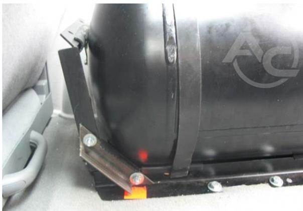
Fotografía 1.3.9 En caso de montaje de depósitos cilíndricos a lo largo del vehículo, es necesario realizar un elemento que limite el movimiento del depósito hacia el frente del vehículo.
