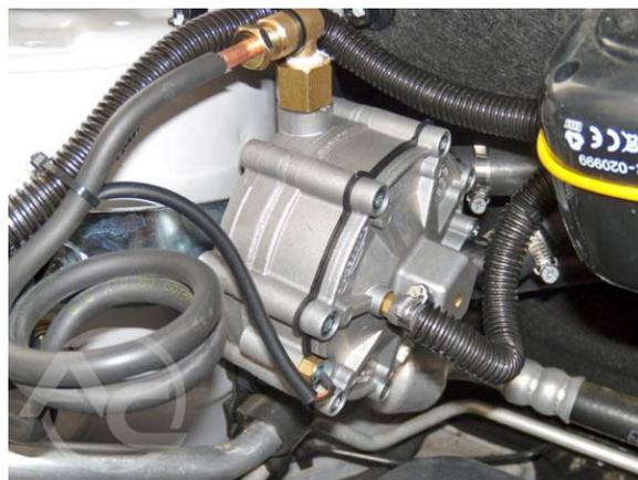
**Fotografía 1.3.26** Conexión del reductor
