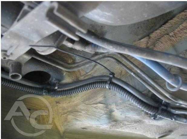
**Fotografía 1.3.21** Fijación de cables eléctricos con abrazaderas
