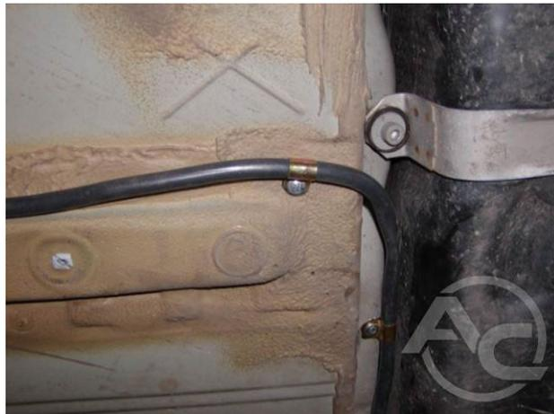
**Fotografía 1.3.22** Fijación con abrazaderas de metal
