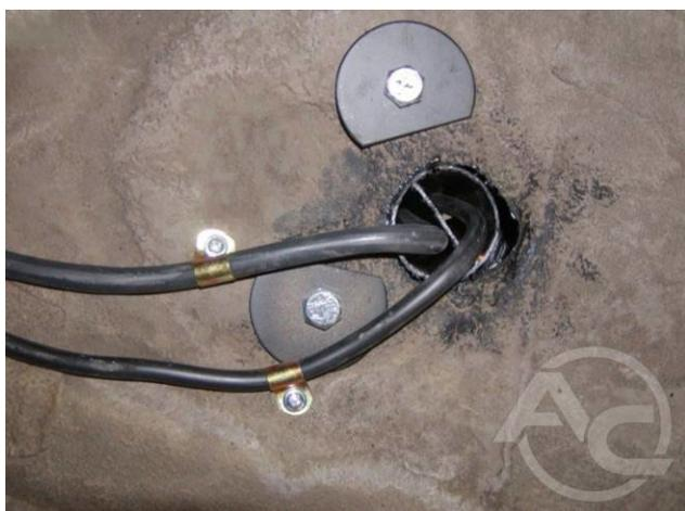
**Fotografía 1.3.20** Paso de los conductos de gas por el chasis
