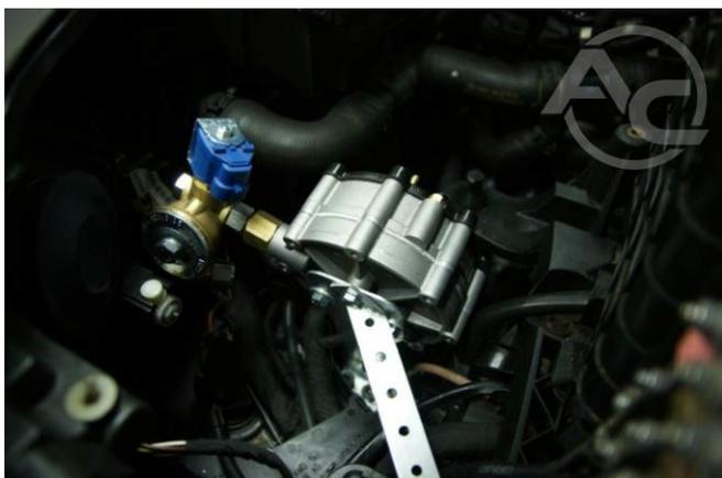
**Fotografía 1.3.25** Montaje reductor
