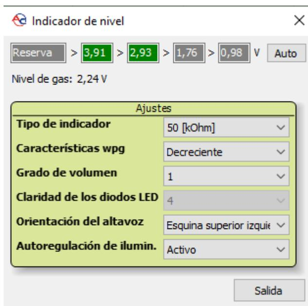
Figura 2.3.2 Ventana de configuración LED-401
