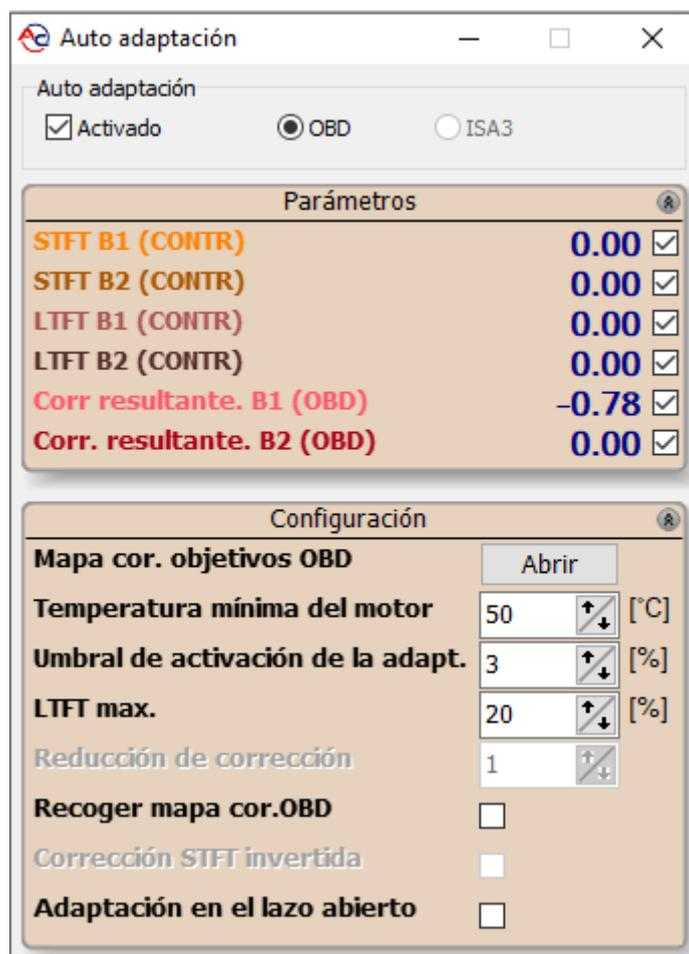
Figura 2.1.33 Configuración de la adaptación OBD
