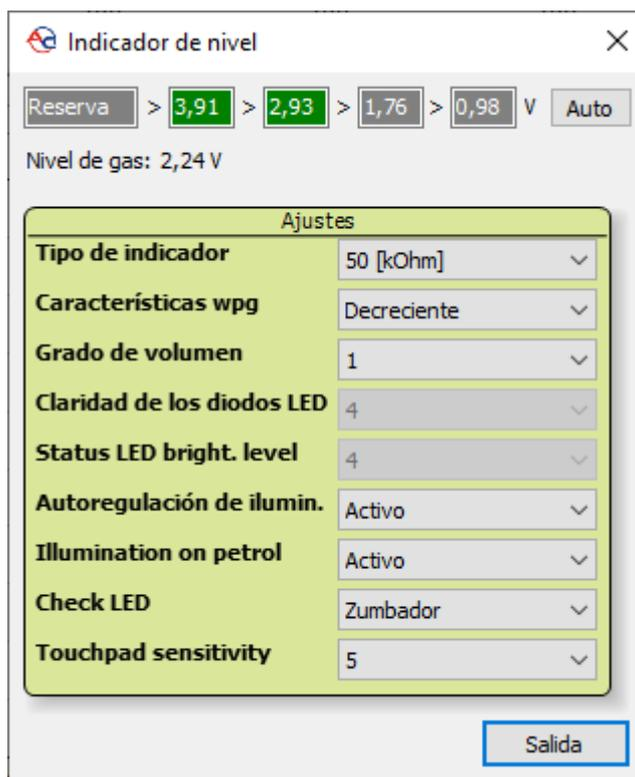
Figura 2.3.4 Ventana de configuración LED-500
