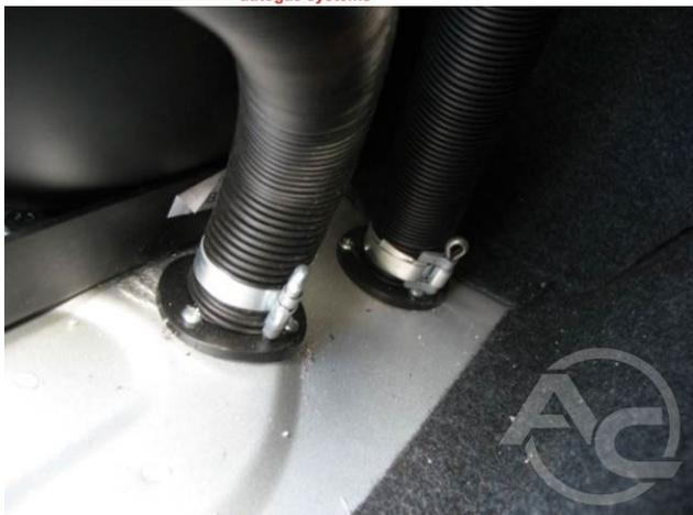
**Fotografía 1.3.16** Tubos de protección montados en el casquillo en el interior del vehículo
