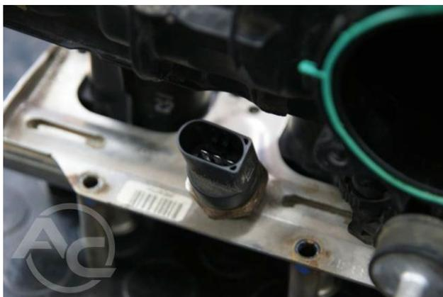
Fotografía 1.3.36 Sensor de presión en el conducto común
