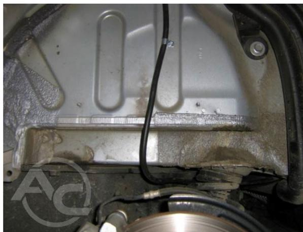
**Fotografía 1.3.6** Fijación del tubo de llenado
