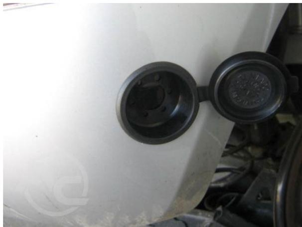
**Fotografía 1.3.2** Montaje de la tapa de la válvula de llenado
