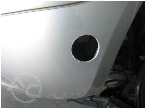
**Fotografía 1.3.1** Realización del orificio en el parachoques
